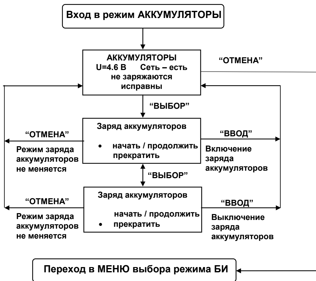
Рисунок Г.1 – Алгоритм управления БИ в режиме "АККУМУЛЯТОРЫ"
